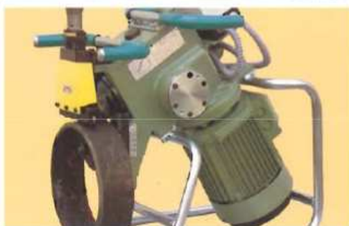
Vista de la máquina realizando la operación de chaflanado en tubos de distinto tamaño. View of the machine bevelling tubes of different sizes. Vue de la machine en train de réaliser l'opération de chanfreinage sur des tubes de taille différente.
