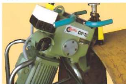
Vista de la máquina realizando la operación de chaflanado en tubos de distinto tamaño. View of the machine bevelling tubes of different sizes. Vue de la machine en train de réaliser l'opération de chanfreinage sur des tubes de taille différente.
