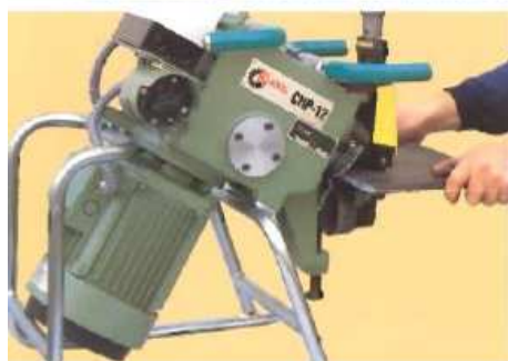
Ejemplo de chaflanado de piezas pequeñas multiformes. Examples of bevelling multi-form little parts. Exemples de chanfreinage de petites pièces multiformes.
