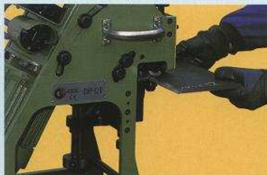
Ejemplos de: Chaflanado de piezas pequeñas multiformes. Examples of: Beveling multi-form little parts. Exemples de: Chanfreinage de petites pièces multiformes.
